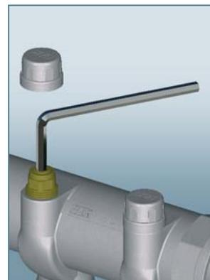
Per il bilanciamento dei circuiti, è possibile impostare, tramite una chiave a brugola da 5 mm, la posizione del detentore micrometrico.
